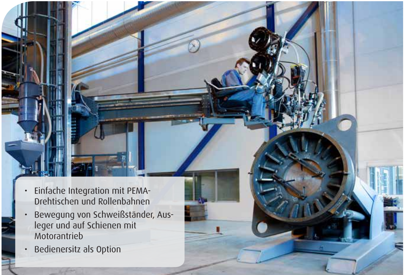
PEMA 6x6 HD Schweißautomatenträger integriert in einen PEMA-Drehtisch
