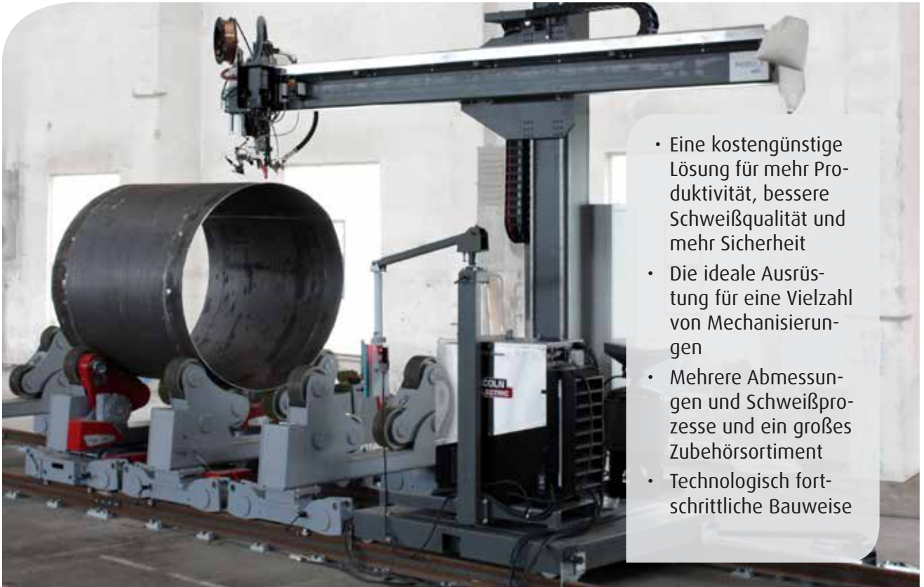
PEMA MD 4x4-Schweißautomatenträger mit einem Satz PEMA-Rollenböcken.
