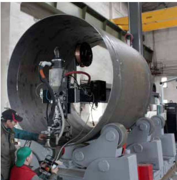
Internes Längsschweißen mit PEMA-Schweißautomatenträger und einem Satz Rollenböcken
