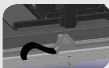
Stromversorgung für die Schienenbewegung.
