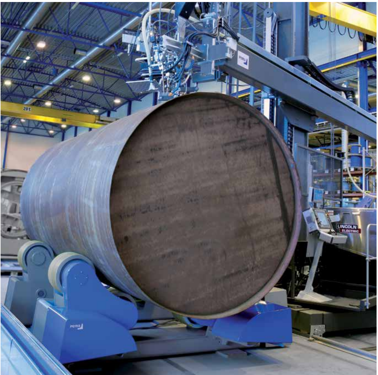
PEMA-Rollenböcke mit PEMA-Schweißautomatenträgern komplettieren selbst die anspruchsvollsten Automatisierungslösungen.
