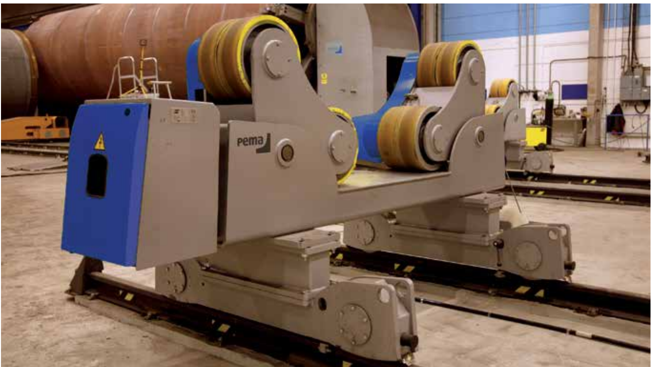
Alle Ausführungen der PEMA-Rollenböcke können mit Schienenwagen ausgerüstet werden, um die Effizienz der Materialflüsse und Produktionsabläufe zu erhöhen.
