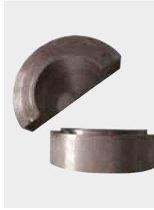
Kammereinsätze für Formteile zum Schweißen von Formstücken
