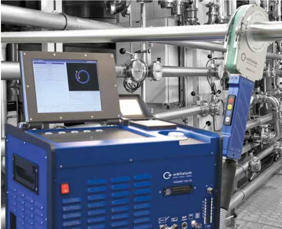
10,5"-Schwenkmonitor und Systemdrucker integriert
