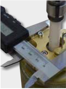
Einfache und präzise Einstellung der Elektrodenposition
