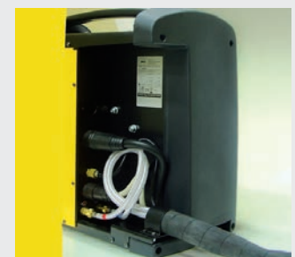
Perfekt angeschlossen und Zwischenschlauchpaket gut geschützt.
