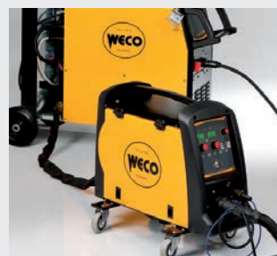
Aufgrund der Inverter-technologie und Software ist es möglich Kabel für mit bis zu 50mtr. Länge einzusetzen ohne die Schweiß-eigenschaften zu verändern.
