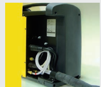
Perfekt angeschlossen und Zwischenschlauchpaket gut geschützt.
